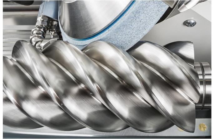
**Die neue, modular aufgebaute Steuerungssoftware Helitouch** erlaubt eine einfache und schnelle Programmierung und damit sehr kurze Rüstzeiten. Die Maschine kann zum Austausch von Programmen und Einstellungen mit anderen Helitouch-Systemen vernetzt werden. Der Einsatz einer speziellen Profilier-Software erlaubt das hochgenaue Schleifen nahezu aller Profilformen.
